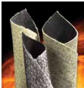
Aramida, fibra de vidrio y acrílico sin tejer parcialmente carbonizado.
